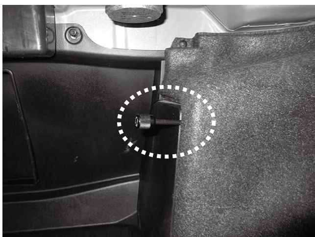
減衰力延長ダイヤル取り付け状態 トランクルーム内装の間より ダイヤルを出しております。
