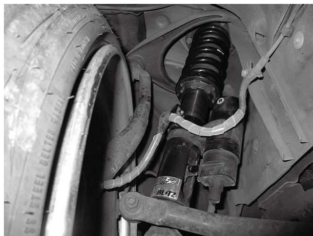
フロント タイヤ・ホイールクリアランス 18×9.0J INSET33 215/40R18装着状態 ※取り付け後クリアランス確認をお願いします。
