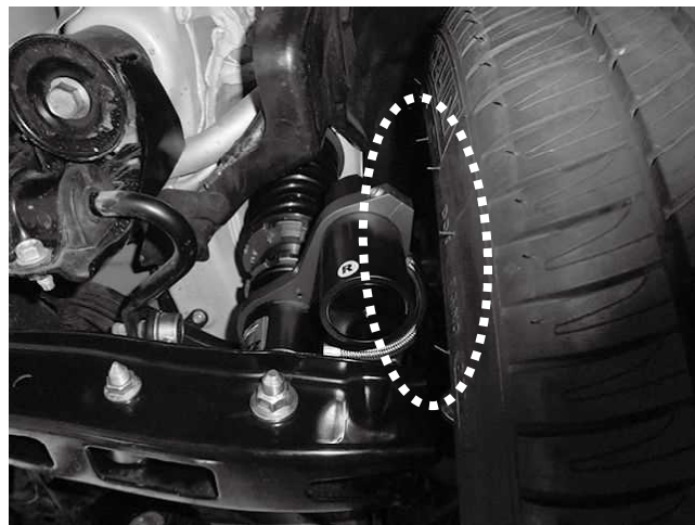
リア タイヤ・ホイールクリアランス 純正ホイール(17インチ)・タイヤ装着状態 ※取り付け後クリアランス確認をお願いします。
