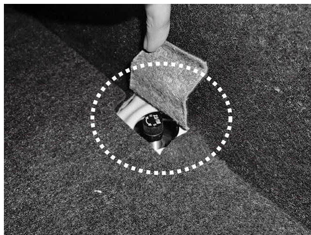
減衰力調整ダイヤルがトランク内装に 干渉する可能性があるので、干渉する際は 上写真のように内装をカットしてください。
