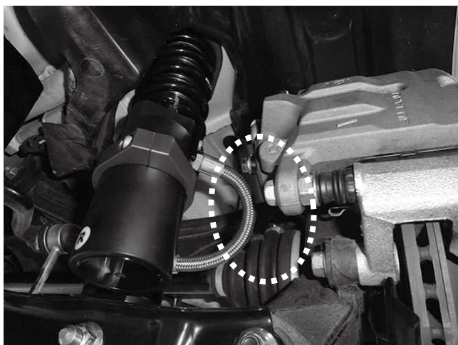
メッシュホースとブレーキライン、 ブレーキキャリパーとの干渉に注意して リザーバートankを固定してください。
