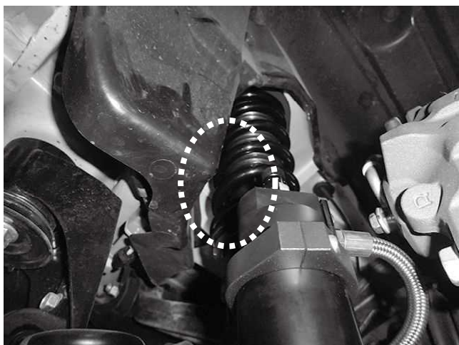
リザーバートankとインナーフェンダーとの干渉に注意してリザーバートankを固定してください。 特に運転席側のカバーが出っ張っています。
