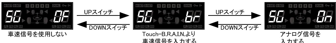
⚠ 車速信号を入力していない(正しく入力されていない)場合に「アナログ信号を入力する」に設定しても車速による減衰力制御はできないので、ご注意ください。
