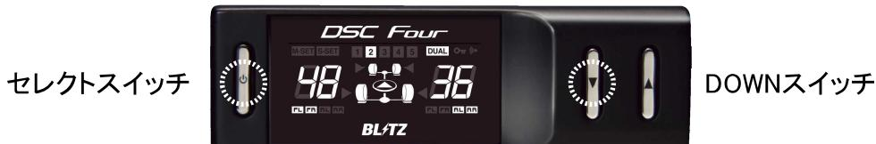
本体の電源を入れ(エンジン始動)、コントローラーの電源が点灯したら、「セレクトスイッチ」と「DOWNスイッチ」を同時に2秒以上押すと設定モードになります。「UPスイッチ」「DOWNスイッチ」で選択し、設定項目は「セレクトスイッチ」を押すことで変化します。
