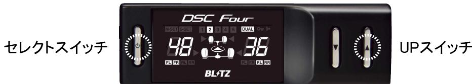
本体の電源を入れ(エンジン始動)、コントローラーの電源が点灯したら、「セレクトスイッチ」と「UPスイッチ」を同時に2秒以上押すと設定モードになります。「UPスイッチ」「DOWNスイッチ」で選択し、設定項目は「セレクトスイッチ」を押すことで変化します。
