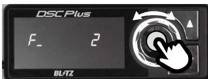
フロント減衰力変更レベル設定「F\_」: 1度の制御で変更する減衰段数
