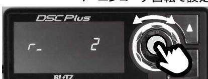
リア減衰力変更レベル設定「r\_」: 1度の制御で変更する減衰段数
