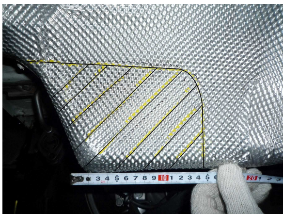
遮熱板カット及びブラケットを入れ替えた状態
