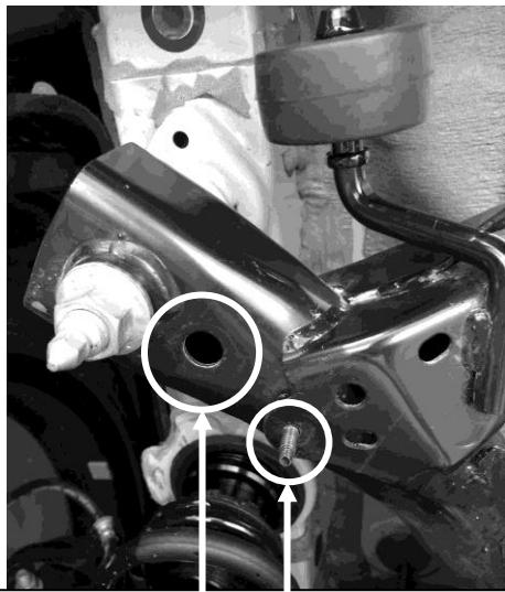
アームに開いている穴と、アームより突き出ているボルトを使用します。
