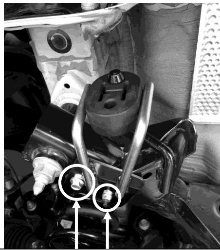
付属のM8ボルトとM6ナットにて、ブラケットをアームに固定します。
