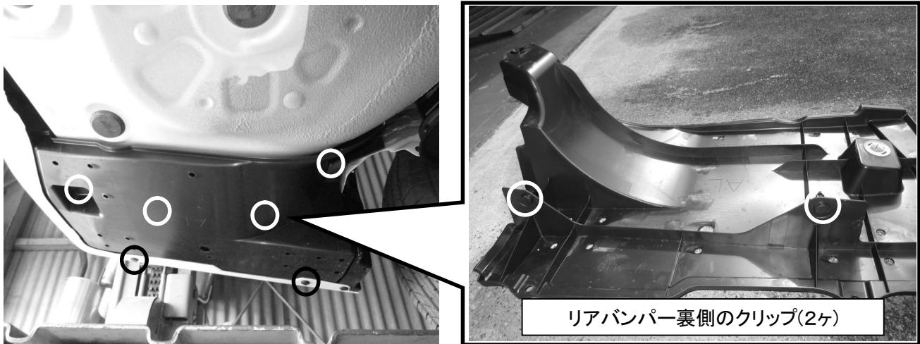
2)写真のようにボディのサービスホール(上側)を使用して、付属のマフラーブッシュを M8 ボルトナットで取り付けてください。ブッシュはボディの外側に止めてください。
