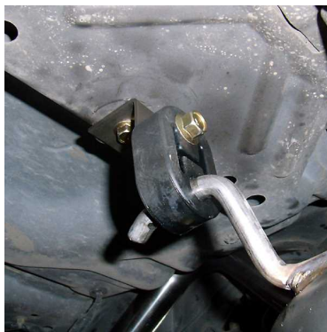
①吊りゴムのブラケット部
