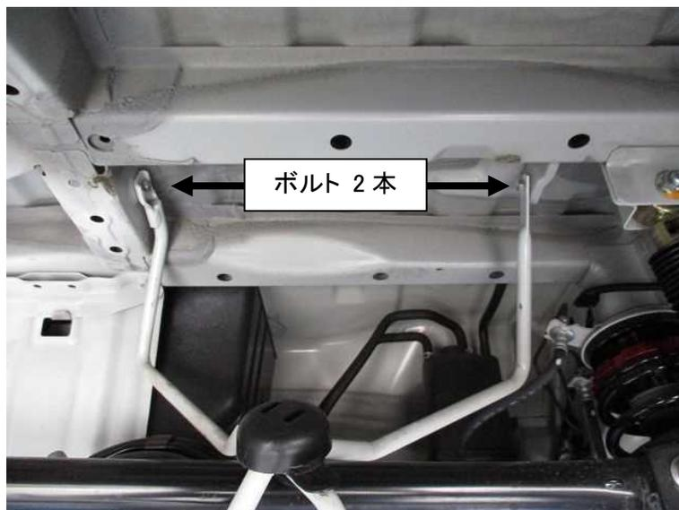
3) 写真を参考にボディに M8 インプルナットを2個挿入します。
