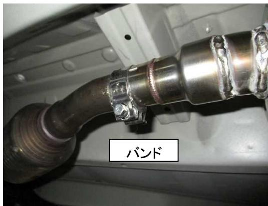
3) 写真を参考に牽引フックに専用ステーを取り付けてから、マフラーを装着してください。専用ステー2枚で牽引フックを挟むように取付け、防振ゴムのM8ボルトとナットで固定します。フロントピースはバンドを緩めると回転します。テール位置を調整してから全体が干渉や無理のない位置に固定できる様に調整してください。
