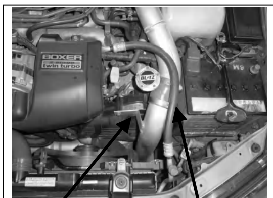
エアコンホース
