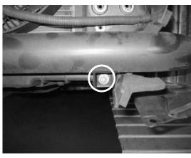
②純正パイプの取り外し(助手席側) 図中〇部のボルトを外して、パイピングと ゴムホースを取り外してください。
