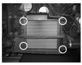
①インタークーラーの取り外し エアガイドクリップ(図中〇部)を取り外し インタークーラーコアを外してください。
