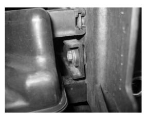
③純正パイプの取り外し(運転席側) ウォッシャータンク横、図中〇部のボルトを 取り外して下さい。 エンジンルーム内ゴムホースとのクランプを 取り外し、車両下部よりパイプを回転させな がら、抜いてください。(マッドフラップが 邪魔な場合は取り外して下さい。)
