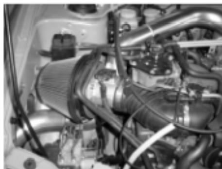
フェンダーとの干渉に注意 純正のエアクリーナーは装着不可
