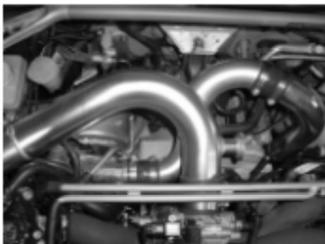
純正ソレノイドへの配管等がパイプ№7に干渉しないように注意 ブレーキマスターシリンダーの配管への干渉に注意 パイプ№1との干渉に注意
