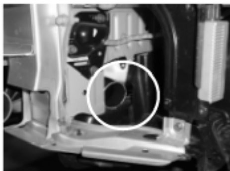
純正ソレノイドへの配管等がパイプ№7に干渉しないように注意 ブレーキマスターシリンダーの配管への干渉に注意 パイプ№1との干渉に注意
