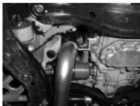
パイプNo.3 ミッションケースに共締め ドライブシャフトとの干渉に注意
