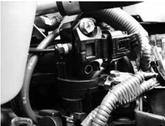
⑤ ホースジョイントにナイロンチューブを挿し込み、純正の圧力センサー固定用のネジでアダプターをエンジンに固定してください。
