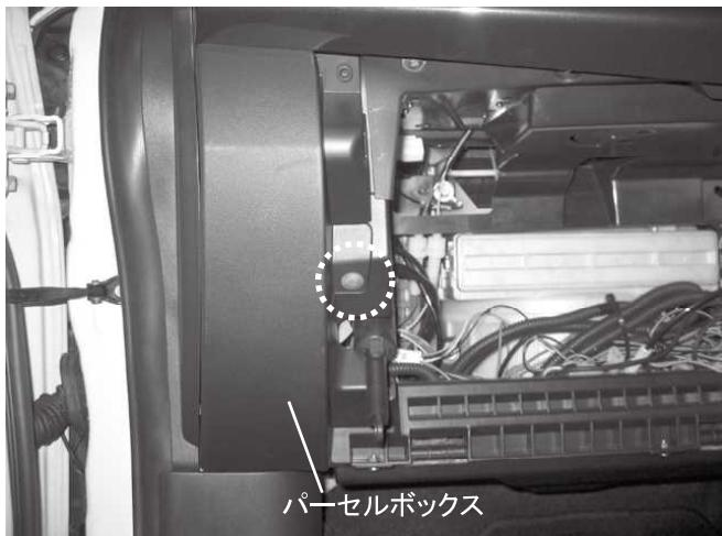
③ パーセルボックスを固定しているスクリュー(1箇所)を取り外してください。
