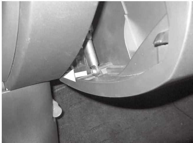
① グローブボックスを開け、グローブボックスダンパーを矢印の方向へ取り外します。
