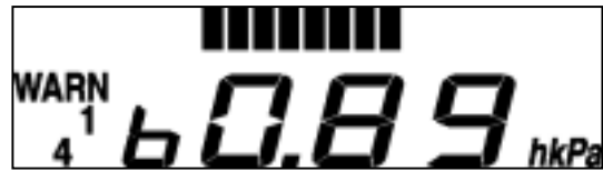
リアル BOOST 表示中の TEMP1、PRESS Hi の複合ワーニング
