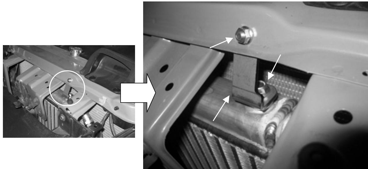
④オイルブロックを付属のセンターボルトを使用して取り付けます。
