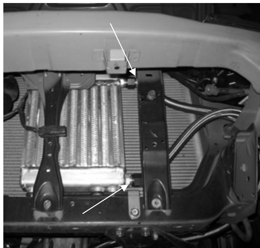
⑧稼動部分等に干渉が無いようフィッティングの位置を調整して、センター bolt、フィッティングを本締めします。
