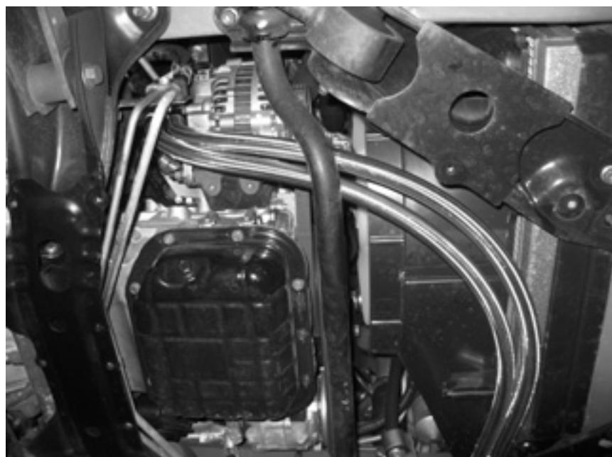
車体フレームとテンションロッドブラケットの間を通して、車両左側ヘッドライトユニットの下側へホースを通します。
