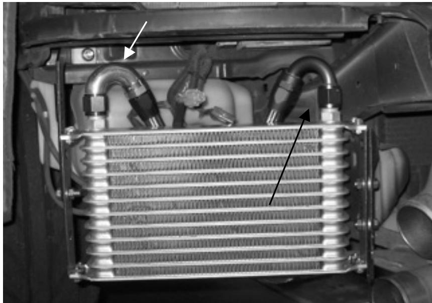
⑨稼動部分等に干渉が無いようフィッティングの位置を調整して、センター螺栓、フィッティングを本締めします。
