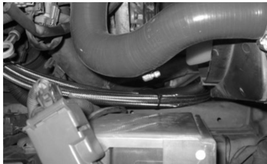
車体フレームとテンションロッドブラケットの間を通して、車両右側コアの後方へホースを通します。
