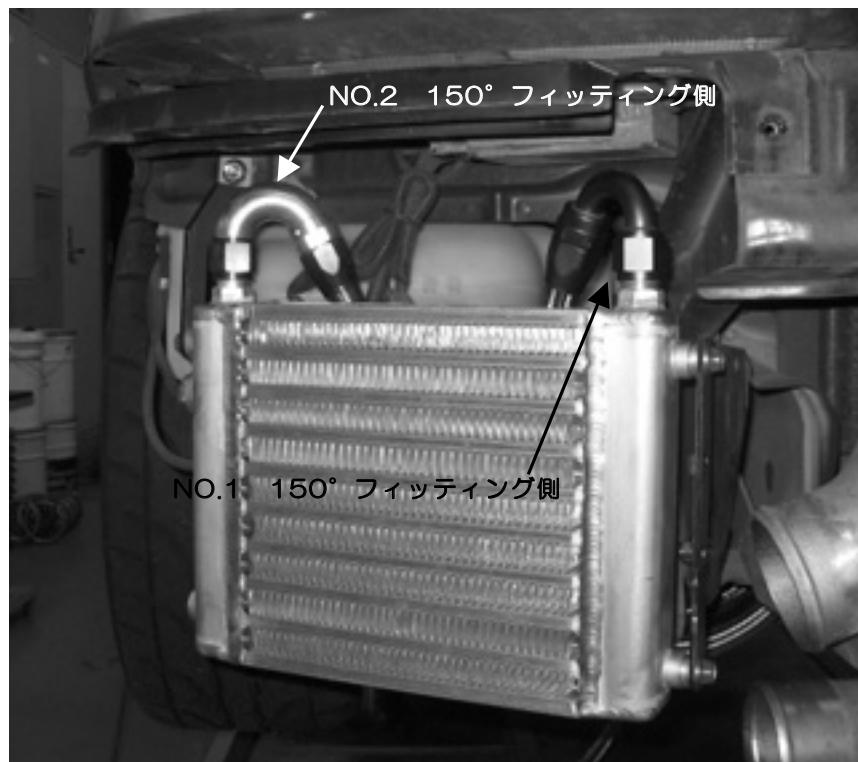
⑧稼動部分等に干渉が無いようフィッティングの位置を調整して、センター bolt、フィッティングを本締めします。
