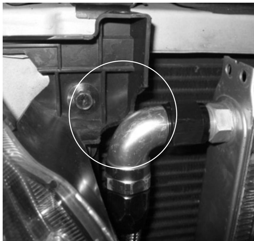
⑨稼動部分等に干渉が無いようフィッティングの位置を調整して、センター bolt、フィッティングを本締めします。
