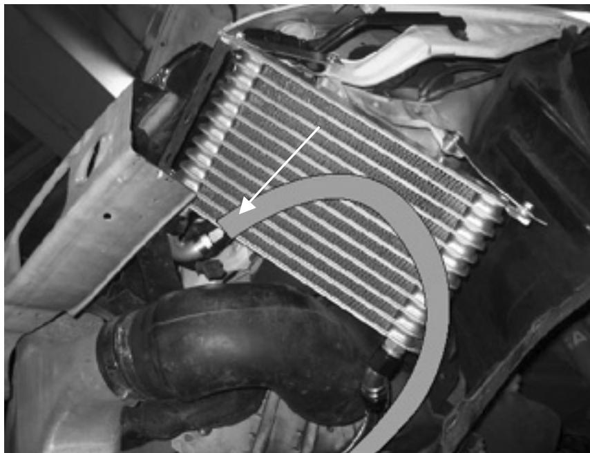
⑩稼動部分等に干渉が無いようフィッティングの位置を調整して、センターボルト、フィッティングを本締めします。
