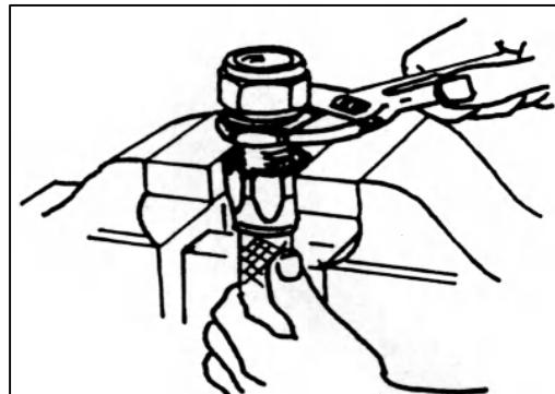
フィッティング組み付け後、角度を変更する場合はAの部分をキズが付かないようにプライヤーで持ち、Bの部分をスパナ等で回してセッティングしてください。
