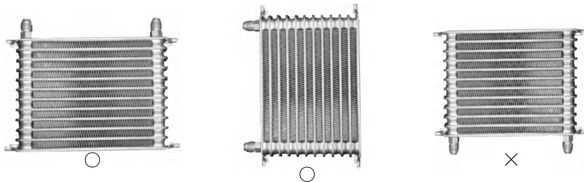
ATFクーラーコアの取り付け、コアの中の空気が、オイルが流れたときに残らないように取付てください。下向きに取り付けた場合、ATFクーラーコア内に空気が残り、コアの半分しかオイルが流れないと恐れがあり、十分に性能を発揮できない可能性がありますので注意して下さい。
