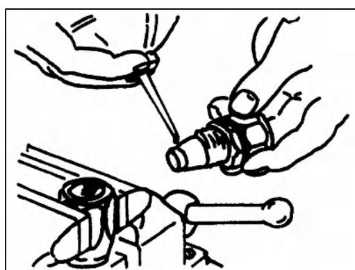
ニップルの先をホースに差し込み、ネジ山が上手くかみ合うように慎重に回しながら押し込んで下さい。手で回せなくなった所で一度バイスから外して、ネジ山がかみ合っているか確認して下さい。
