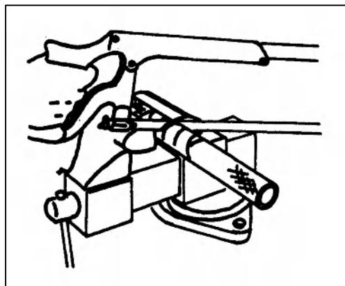
ソケットをバイスにはさみ（ソケットが変形しないよう注意）ソケットのネジ山の手前までホースを挿し込んで下さい。
