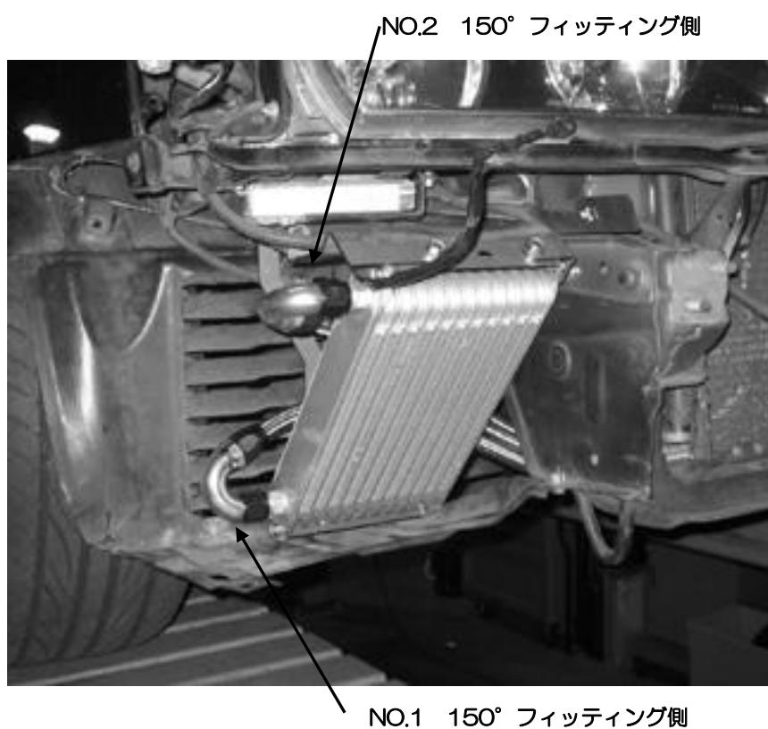
⑪稼動部分等に干渉が無いようフィッティングの位置を調整して、センター ボルト、フィッティングを本締めします。
