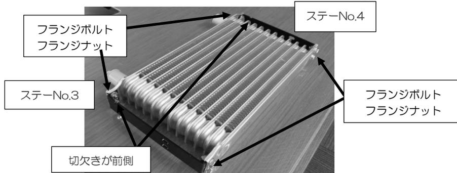
⑦オイルクーラーコアとステアNo.1、ステアNo.2をフランジボルト M6×16 4個、フランジナット M6 4個を使用して仮止めしてください。エアコンコンデンサーとの干渉を防ぐため、オイルクーラーコアはできるだけ垂直になるように位置を決めしてください。
