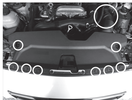
クリップ 8 か所、ダクト接続部 1 か所
