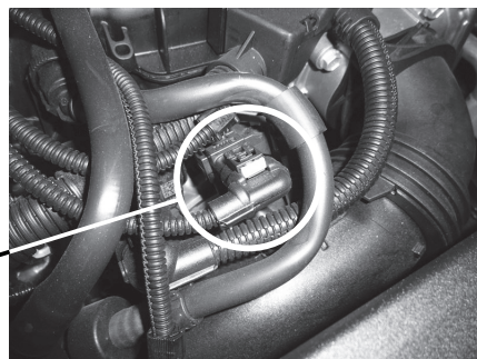
圧力センサー（サブ側）
