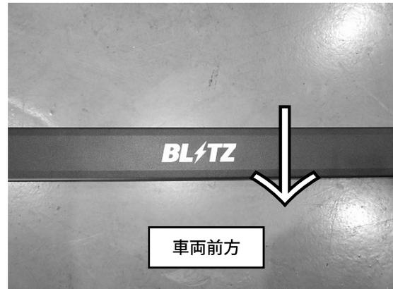
※仮合わせ時に各部の干渉がないか確認してください。8AR-FTSエンジンの場合、冷却水リザーバータンクとストラットバーが近いのでストラットバーを上げた状態で取り付けてください。
