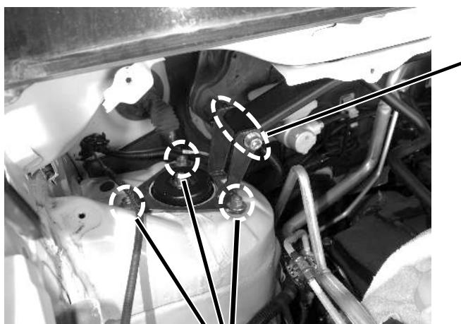
タワーバーシャフト部ボルト、ナット締め付けトルク
