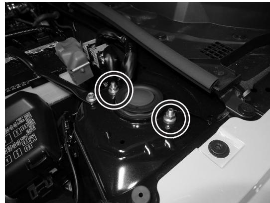
2. タワーバーブラケット及びタワーバーシャフトを車両に仮合わせし、各ボルト及びナットを仮止めします。
