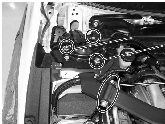
アッパーマウント上部取り付けナット締め付けトルク
