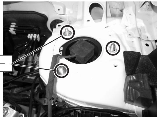
3. ストラットバーシャフトのボルト、ナットを仮締めし車両に仮合わせします。ストラットバーシャフトのロゴ向きを間違えないように取り付けてください。
