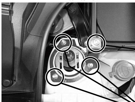
ストラットバーシャフト部ボルト締め付けトルク
