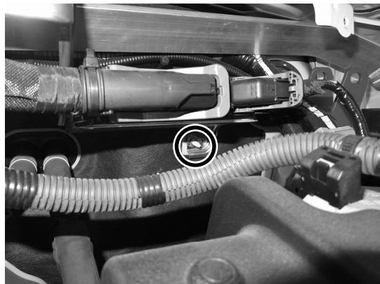
4. ストラットバーシャフトのボルト、ナットを仮締めし車両に仮合わせします。ストラットバーシャフトのロゴ向きを間違えないように取り付けてください。
