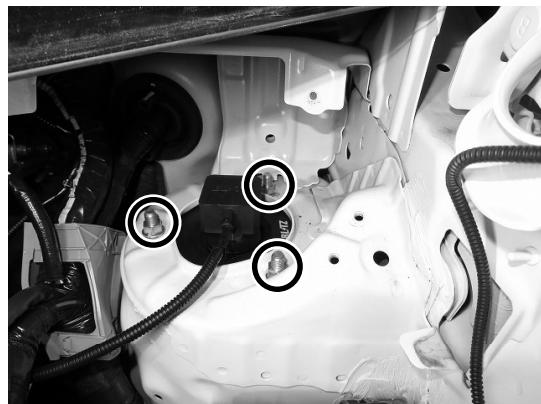
3. 画像を参考に一部車種はコンピュータステーの固定ボルト、ナットを一度取外します。
