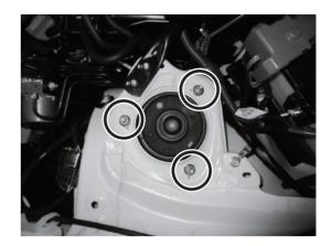
2. アッパーマウント上部にタワーバーブラケットを仮合わせします。タワーバーシャフトのボルト、ナットを使用してタワーバーシャフトを仮合わせします。 タワーバーシャフトのロゴ向きを間違えないように取り付けてください。
