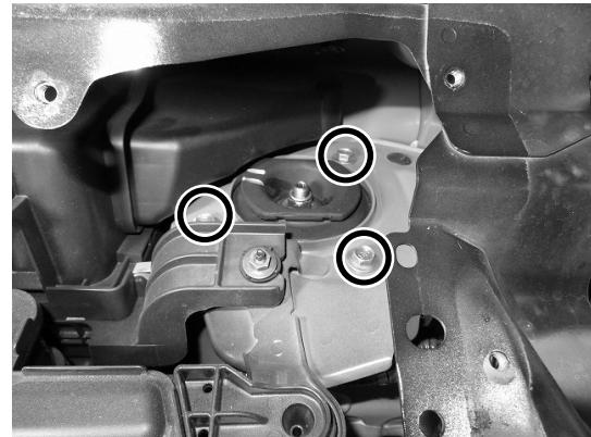
3. 取り外したボルトの1ヶ所にキット付属のM10平ワッシャー(厚2mm)をセットしてください。運転席側も同じ位置にワッシャーをセットしてください。
