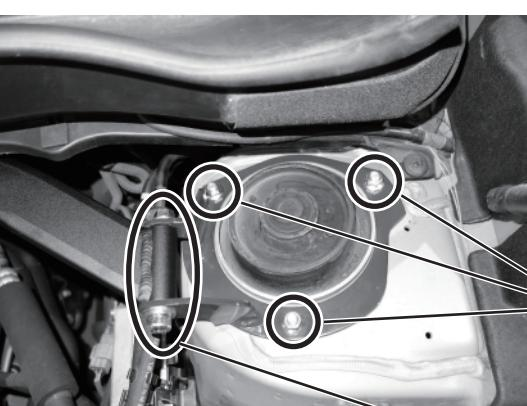
※ボルト、ナットの破損の原因となりますので、締め過ぎに注意してください。
