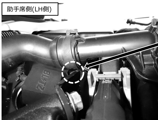
M10フランジナットとECUコネクタのクリアランス 約4mm
