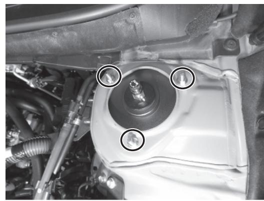
2. タワーバーブラケット及びタワーバーシャフトを車両に仮合わせし、各ボルト及びナットを仮止めします。
