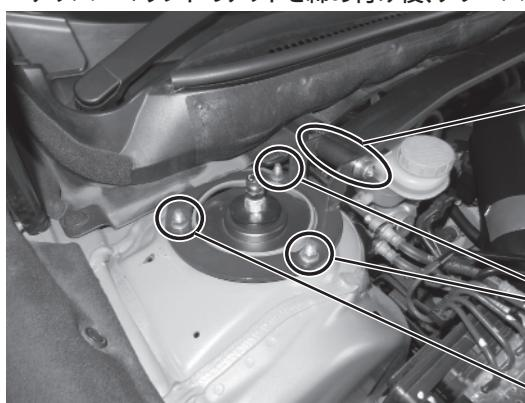
タワーバーシャフトのボルト、ナット締め付けトルク
