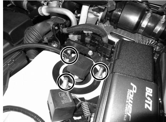
2. ストラットバーシャフトのボルト、ナットを緩め車両に仮合わせします。ストラットバーシャフトのロゴ向きを間違えないように取り付けてください。
