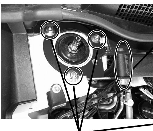
ストラットバーシャフト部ボルト、ナット締め付けトルク
