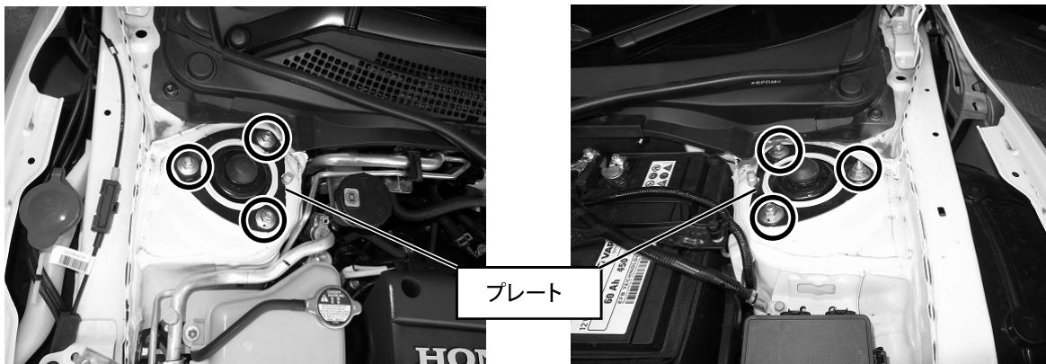
2. ストラットバーシャフトのボルト、ナットを仮締めし車両に仮合わせします。ストラットバーシャフトのロゴ向きを間違えないように取り付けてください。
