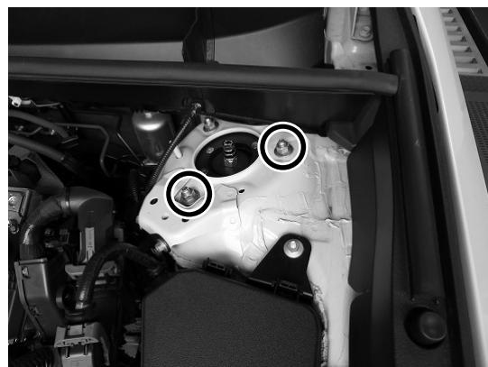
2. ブレーキフルードタンクステーがある車両はボルトを外した箇所にM8カラーを設置します。
