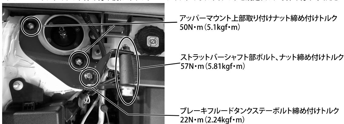
6. ブレーキフルードタンクハーネスがシャフトに干渉する場合は付属のスパイラルチューブで保護してください。
