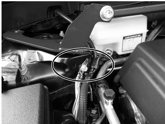
5. 付属のM10 P1.25 フランジナットを使用しブラケットを規定トルクで締め付けます。
