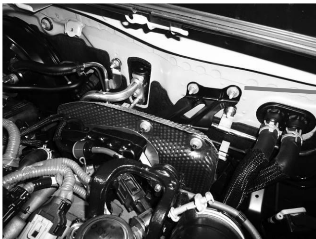
ダッシュパネルヒートインシュレータ ボルト (3本) 締め付けトルク : 5Nm
