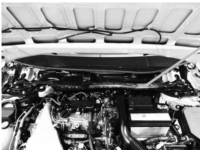
カウルトッププレート ナット (4個) 締め付けトルク : 50Nm
