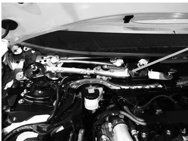
ワイパーモーター ボルト (3本) 締め付けトルク : 5.4Nm
