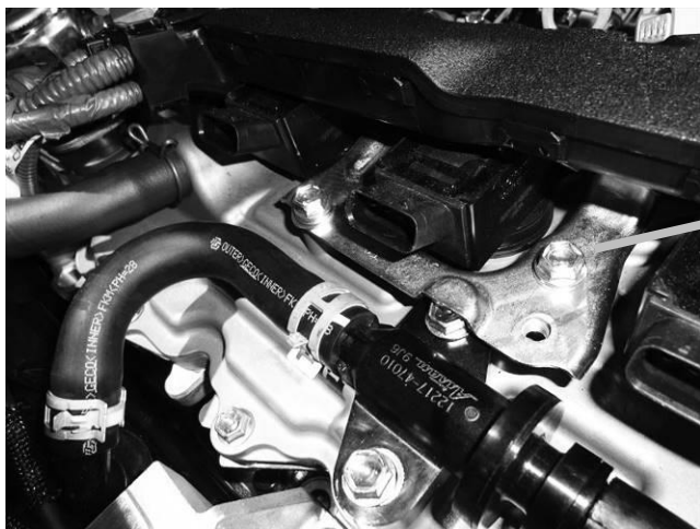
ワイヤーハーネスクランプブラケット ボルト (2本) 締め付けトルク : 8Nm
