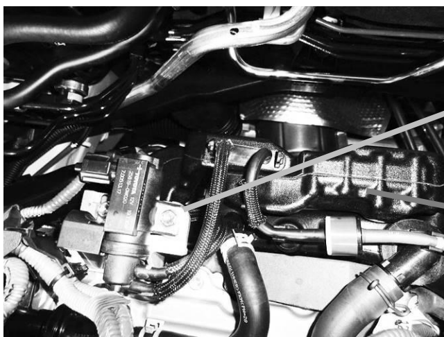
バキュームレギュレーションバルブ ボルト (2本) 締め付けトルク : 10Nm
