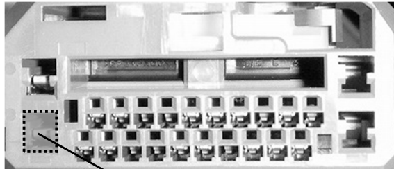
下段の一番左側が常時電源線です。
