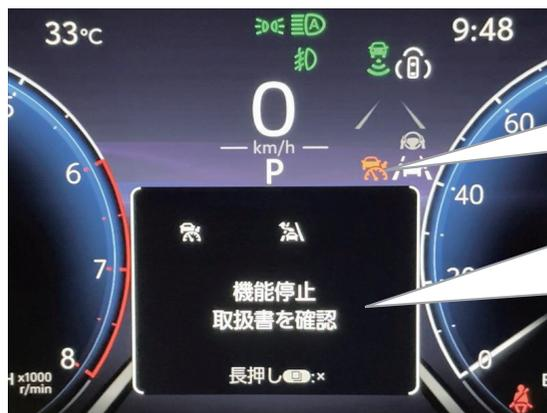
レーダークルーズコントロールのアイコンが橙色で点灯し、システム異常と判断され、機能が停止します。
