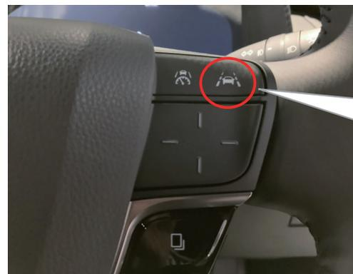
上記のエラー表示が表示中に、レーンレーシングアシスト (LTA) ボタンを押すことで、エラー表示を消すことができます。
