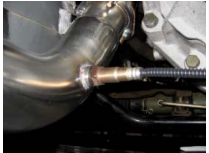
15063 A/F BOX の A/F センサー装着例
