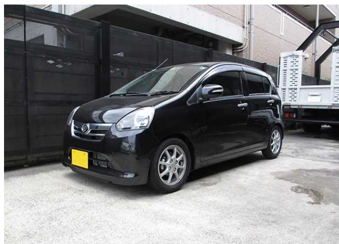
フロント:-40mm ダウン / リア:-35 mmダウン
