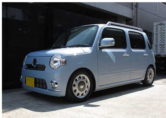
フロント:-60mm ダウン / リア:-50 mmダウン
