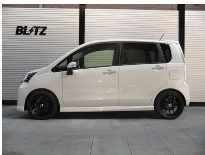
フロント:-30mm ダウン / リア:-20 mmダウン
