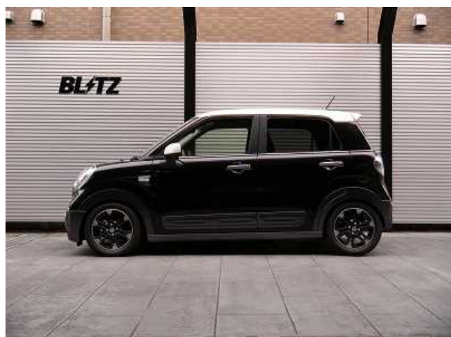
フロント:-70mm ダウン / リア:-55 mmダウン
