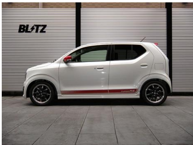
フロント:-35mm ダウン / リア:-33 mmダウン
